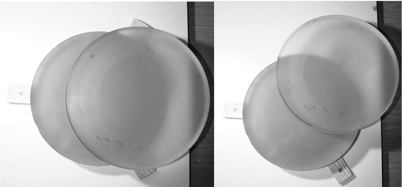
Beim Schleifvorgang sollte der Spiegel leicht in eine Richtung gedreht werden, damit er gleichmäßig geschliffen und Astigmatismus vermieden wird. Bei kleineren Spiegeln wie 8" ist das noch relativ unkritisch, da sie recht dick im Verhältnis zum Spiegeldurchmesser sind. (25mm)
