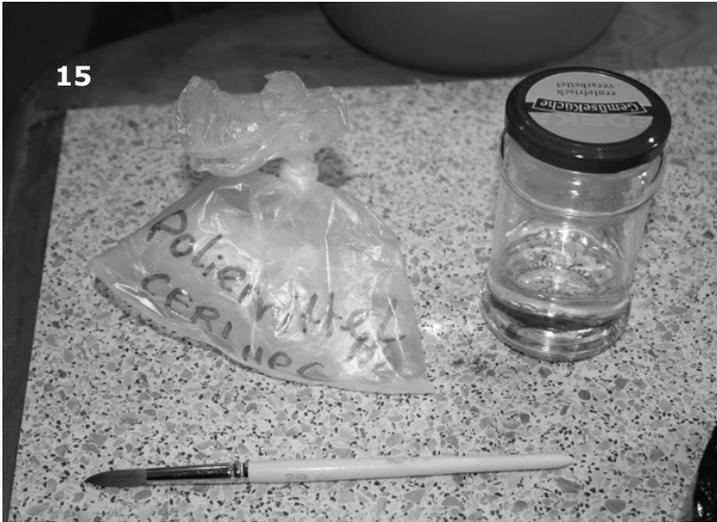
Das Poliermittel wird mit Wasser zu einer Suspension verrührt.
